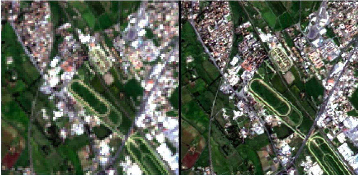
Figura 14.4: ejemplo de pan-sharpening de una imagen Landsat 8. Izquierda, bandas originales multiespectrales (30m); derecha, bandas con nueva resolución (pan-sharpened, 15m)
