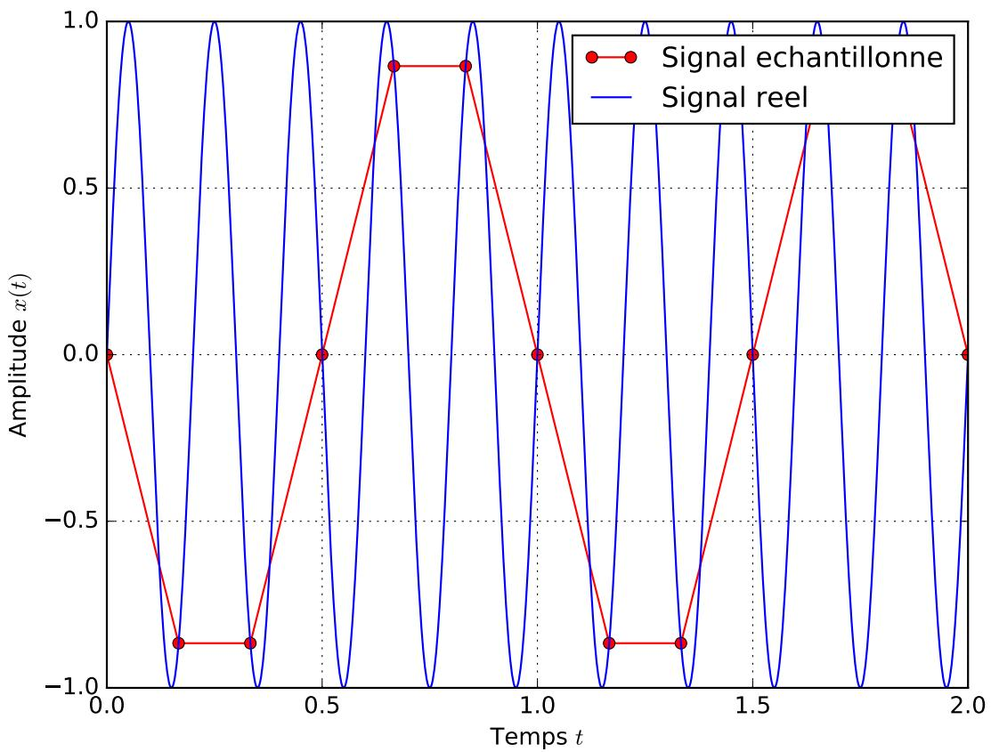
Pour échantillonner un signal, il est donc essentiel de retirer préalablement les composantes de fréquence  $f \geq f_e/2$  à l'aide d'un filtre anti repliement.
