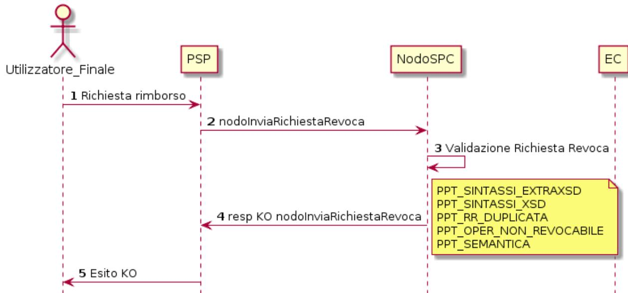
Figura 6: Diagramma di sequenza nel caso di RR rifiutata dal Nodo
