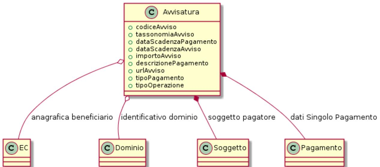
Figura 10: Diagramma delle relazioni degli attributi dell'Avvisatura
