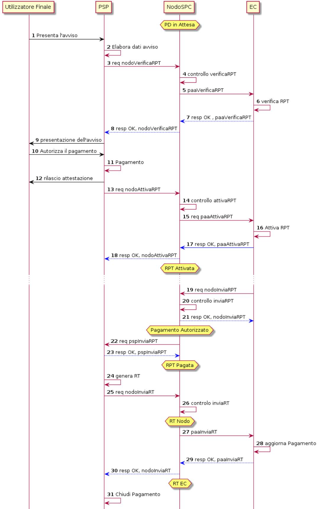
**Figura 2: Diagramma di sequenza del pagamento con avviso di pagamento ( scenario alternativo)**
