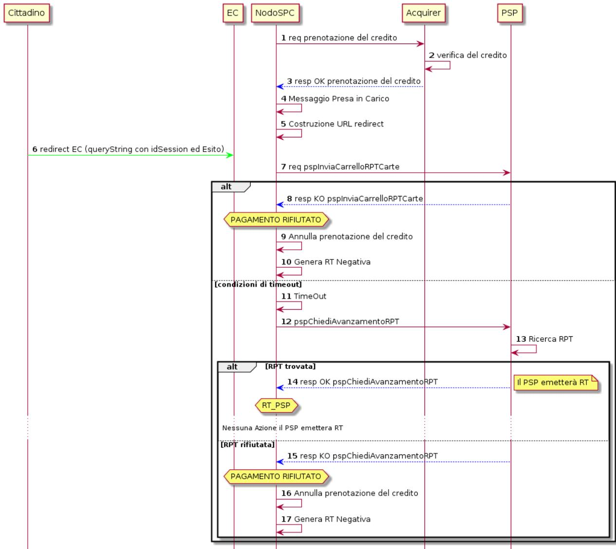
**Figura 4: Diagramma di sequenza del pagamento non contabilizzato**
