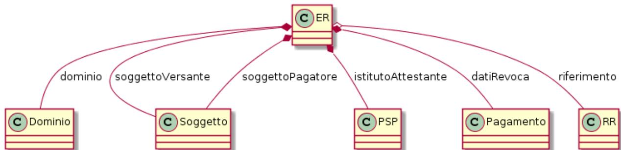
**Figura 6: Diagramma delle classi dell'Esito della Revoca**
