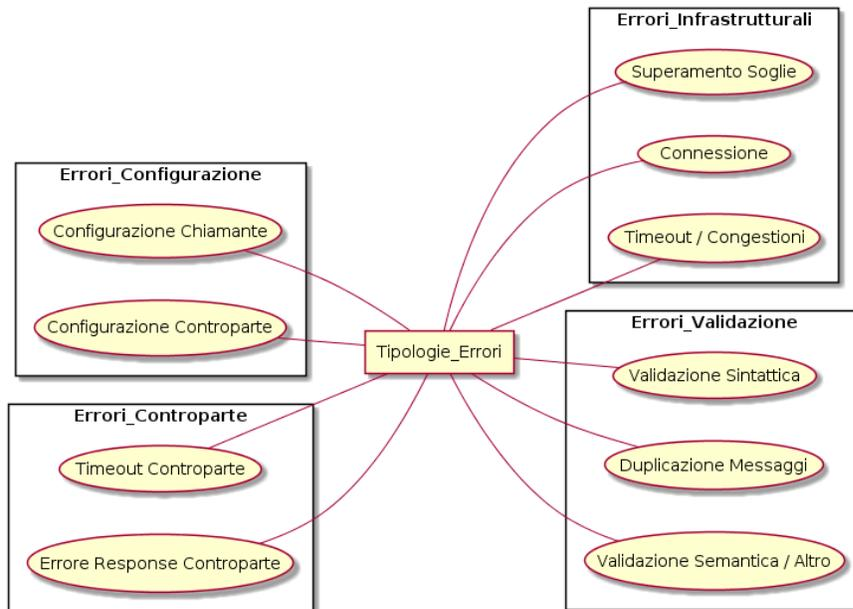
**Figura 3: Raggruppamento delle possibili tipologie di errori**
