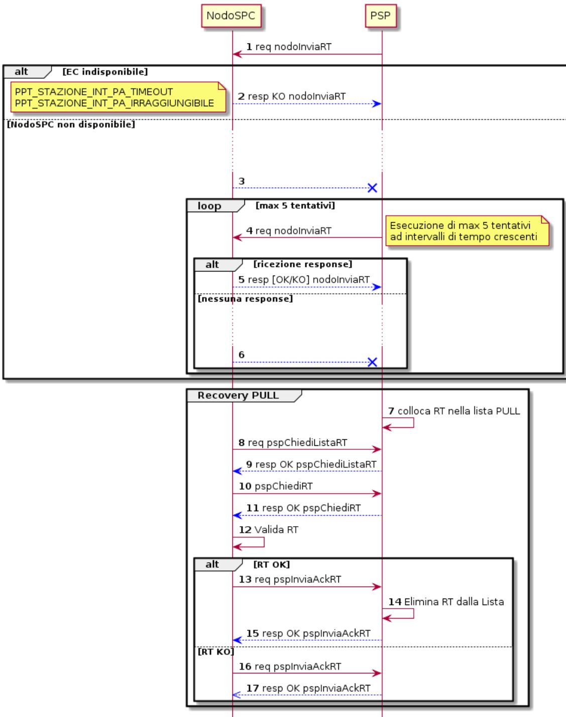
**Figura 10: meccanismi di recovery per RT PUSH**
