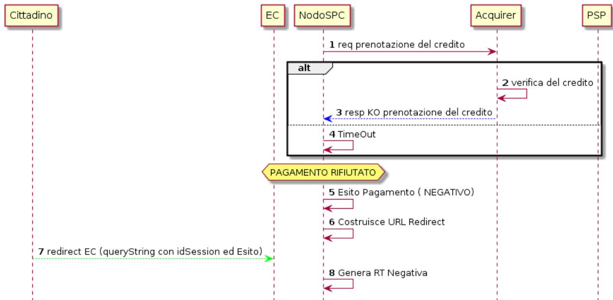
**Figura 2: Diagramma di sequenza della prenotazione rifiutata**
