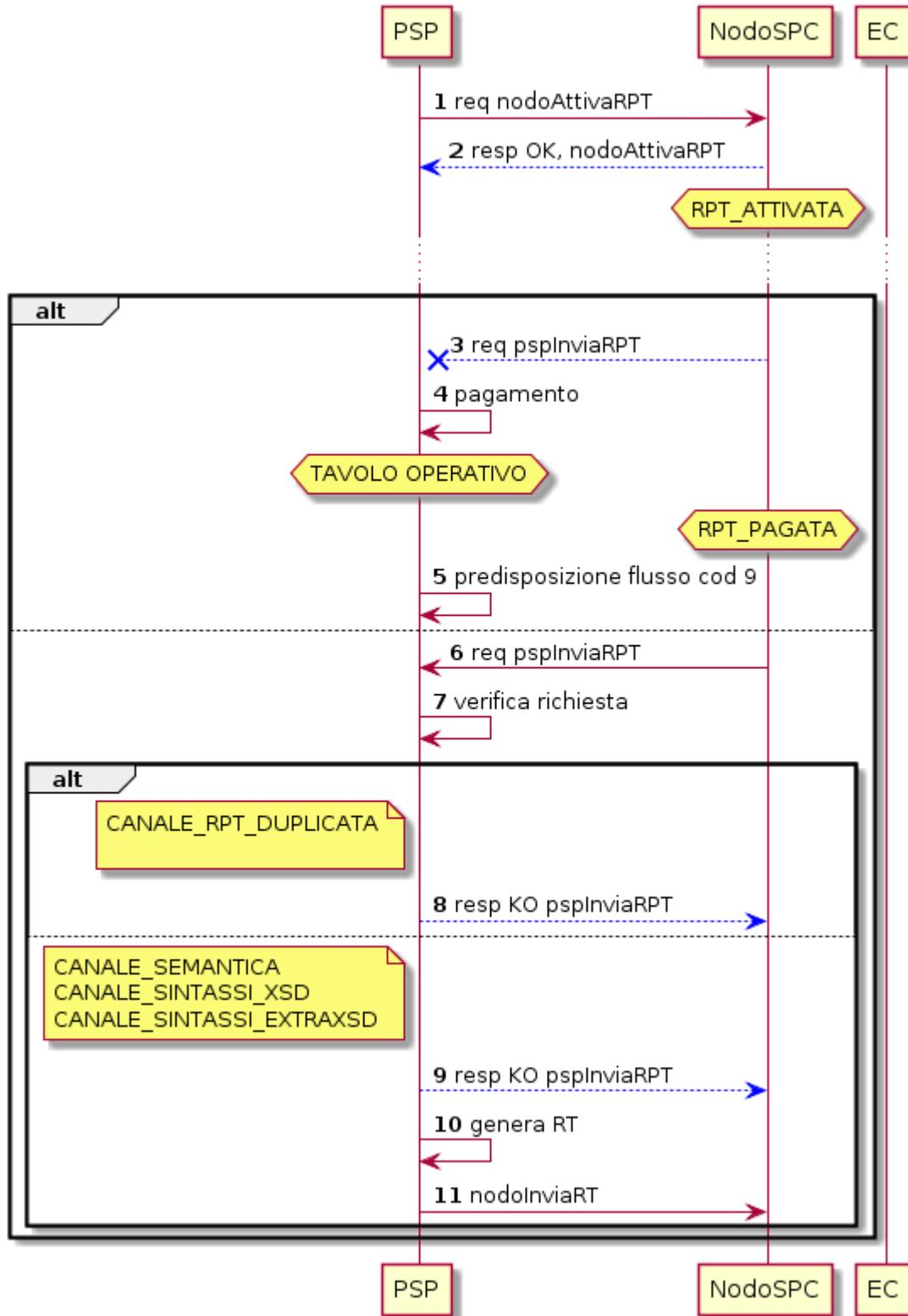
**Figura 5: Pagamento eseguito in assenza di RPT**
