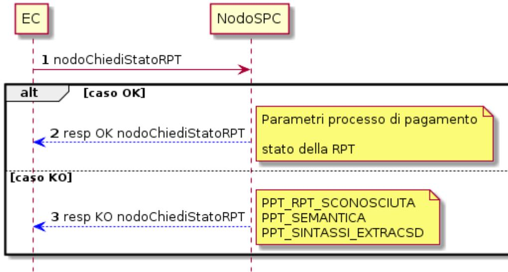
**Figura 4: Verifica dello stato di una RPT**
