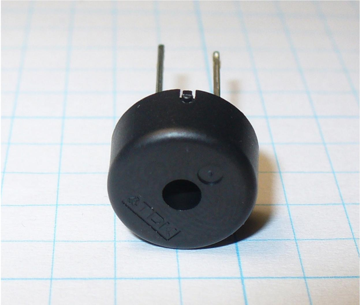
Ces petits appareils émettent un bip aigü lorsqu'ils sont connectés à un circuit. Pour en relier un à ton micro :bit, tu dois raccorder une pince crocodile aux pins 0 et GND (voir ci-dessous)
